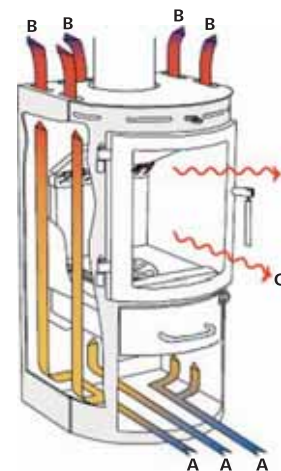
A Kald luft B Konveksjonsvarme C Strålevarme
